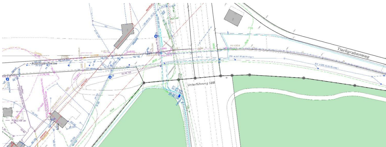
Abb. 5 Ausschnitt aus dem Werkleitungskataster HASTAG (Zürich) AG, Kieswerk Wil; mit den weiteren Werkleitungen wie GWS, GWVR, EKZ, Swisscom
