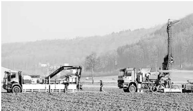
*An ausgewählten Punkten des Messgebiets werden sogenannte Aufzeitmessungen durchgeführt. Zu diesem Zweck werden in Gebieten mit komplexer Oberflächengeologie flache Bohrlöcher durch die Lockergesteine bis unterhalb der Felsoberkante abgeteuft. In diesen Bohrlöchern kann die Ausbreitungsgeschwindigkeit der seismischen Wellen mit der Tiefe bestimmt werden und diese Information wird zur Kalibration bei der Datenbearbeitung berücksichtigt.*
